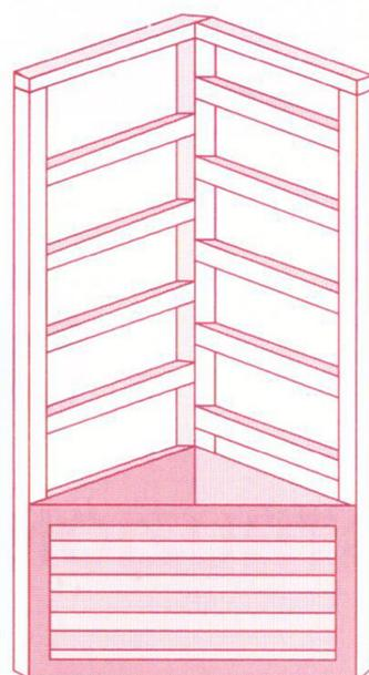
Dopo aver montato le due spalle, inserire sul fondo il pannello per la fioriera (fig. 2)
